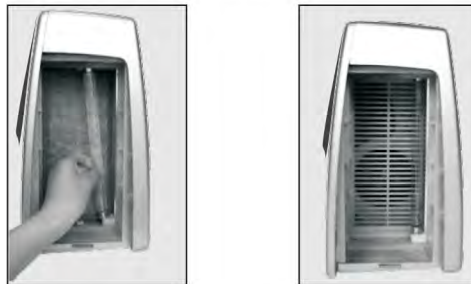
Innstallering av UV-lampen
